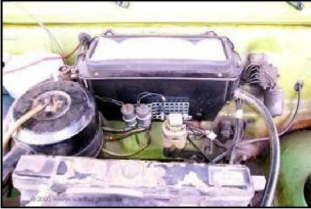
Vorratsbehälter befindet sich statt des Motors nur ein Schlauch, welcher über ein T-Stück beide Pumpen versorgt. Das funktioniert recht gut. Leider ist eine Pumpe undicht und mir tropft allmählich der Behälter leer . . .
