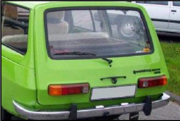
Die recht tief liegende Anordnung der Düsen an der Heckklappe sorgt stets für unfreiwillige Befeuchtung des Kennzeichens (Niveau = Vorratsbehälter). An der Heckklappe hätte ich die Düse besser oberhalb der Heckscheibe platzieren sollen. Natürlich liebäugle ich auch mit einem Wischermotor, bei dem das Waschwasser durch die Achse geführt wird. Ich konnte jedoch nichts finden, was bei den Wartburgplatzverhältnissen eingebaut werden könnte.
